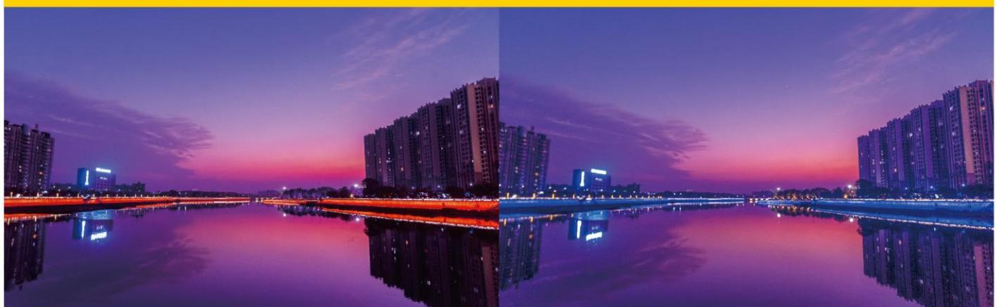
河道的亮化覆盖范围东至新城路,西至南环路,全长3500多米,形成一个半合围的彩色灯光景观带。河道驳岸高约4m,墙面作为一个很好的载体,让灯光充分发挥其魅力。此处使用的是LiteMagic W6304 RGB线形洗墙灯,洗墙灯均匀地洗亮驳岸,连绵不断地变动着色彩。
