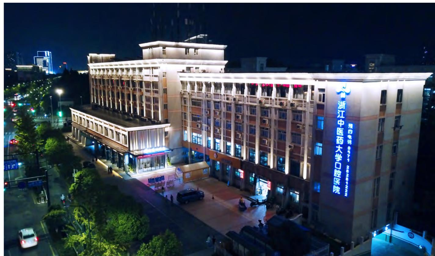
作为浙江中医药大学附属的口腔医院，洗墙灯W6302和投光灯F6201则应用于建筑顶部。iGrazer W6302选用功率28W、10°\*60°发光角度，3000K暖白光向下洗亮墙面，优异的出光效果突出顶部结构；投光灯GiantEco F6201以1米的间隔安装在顶部下方墙根处，30°发光角度向上投洗顶部，形成有序的明暗分布，突显照明设计的美感。
